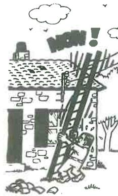
• Manœuvrer une échelle métallique à proximité d'une ligne.
