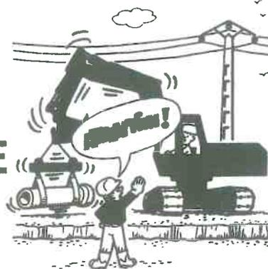
• La manœuvre d'une grue ou d'une pelle mécanique: elles peuvent entrer en contact avec une ligne sous tension.
